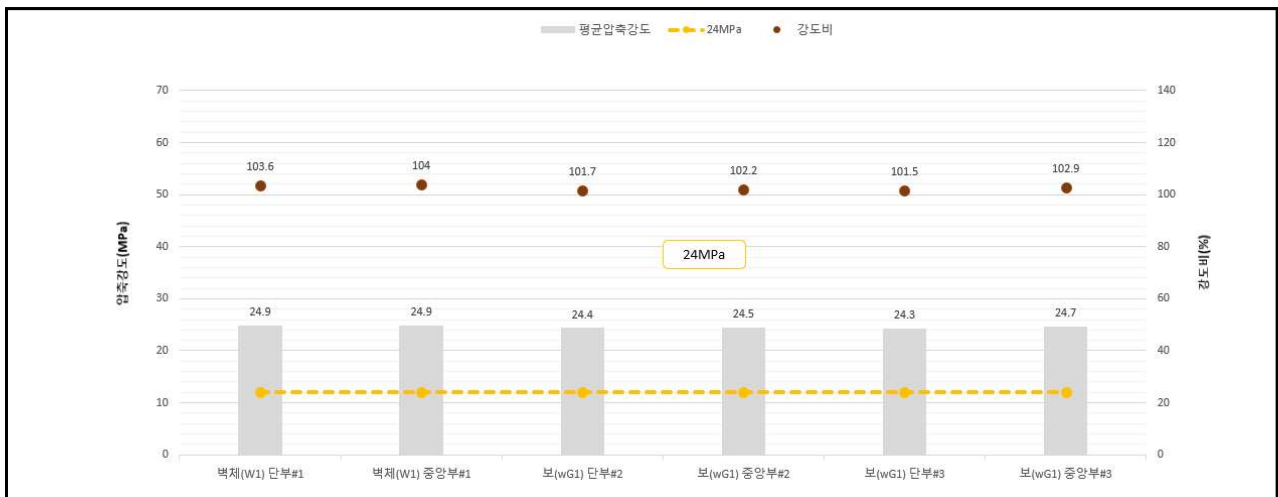
【그림 4.3】 반발경도시험 측정결과 그래프(건축)
